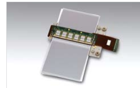
写真(右): CMS実験装置に取り付けられたシリコン・ストライプ・ディテクタ [画像提供:CERN]
