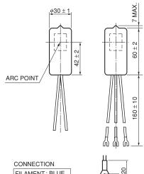
FILAMENT: BLUE FILAMENT : BLUE ANODE : RED
