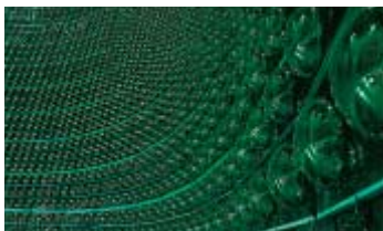
カミオカンデを大規模化したスーパーカミオカンデの内部に取りつけられた20インチ光電子増倍管
