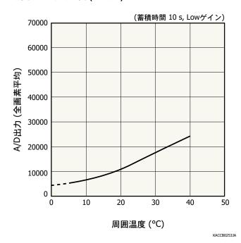
A/D出力は、センサおよび回路のオフセット出力と センサ暗出力が加算されたものです。
