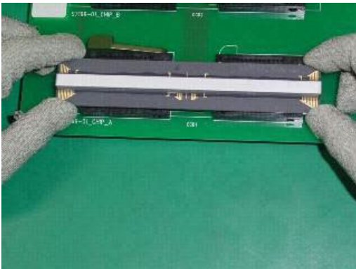
[写真 7] 基板を押し込んで挿入する
