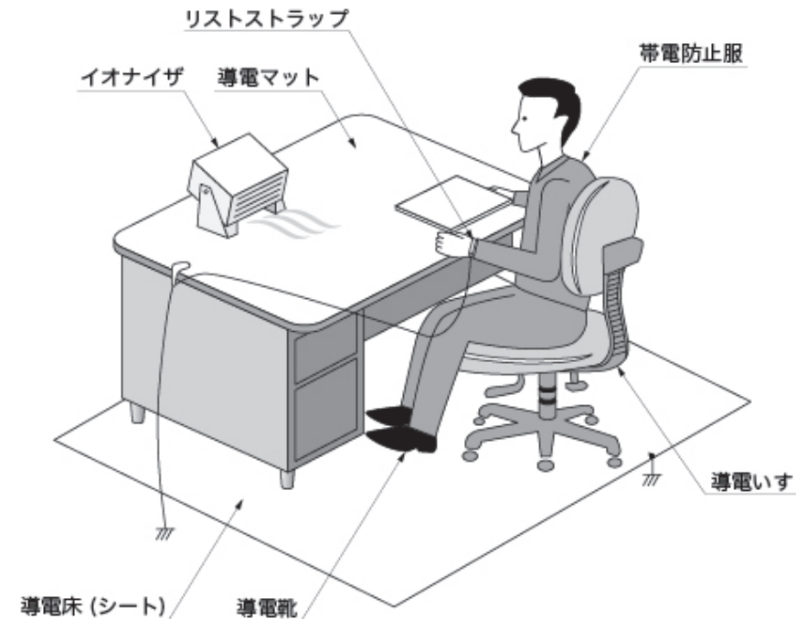
[図 2] 静電気対策の例
