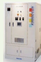
PFC除害装置
