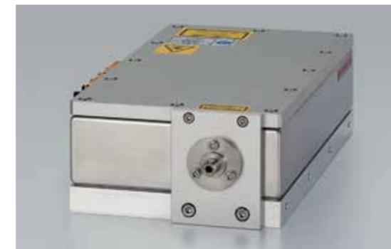
L13705-20-940DAはレーザ樹脂溶着に使用される光出力200 Wファイバモジュールです。従来は高圧純水で強冷却していましたが、高効率化技術と構造設計の最適化により、レーザダイオードバー数を2/3に低減させた上で、電気-光変換(E/O)効率を7%向上させ、省エネルギー化を実現しました。また小型軽量の汎用チラーによる低圧蒸留水で冷却可能となりました。
