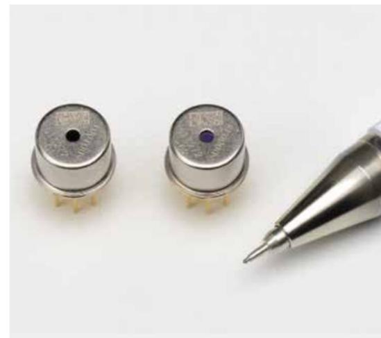
C13272シリーズは印加電圧により透過波長を可変できる近赤外分光センサです。近赤外線はプラスチックの選別、ガス分析、水質分析といった環境や食品選別の分野で広く利用されています。
