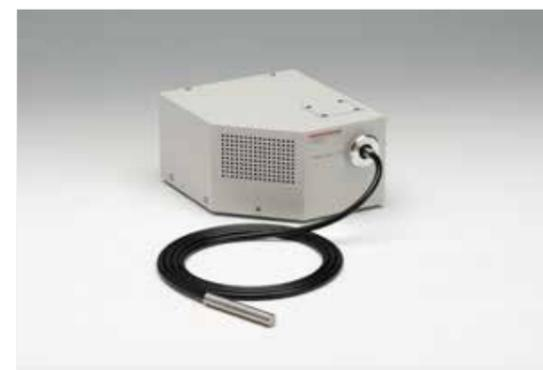
C12823は、高速で測定再現性の高いLED評価用の分光測光装置です。BT-CCDセンサの採用や起動回路の改良により、従来品よりも高速化、高感度、低迷光を実現した上で、小型化、低消費電力を実現しました。
