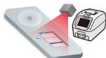
吸光法 試薬に可視光を照射し 発色をイムノクロマトリーダで確認する
