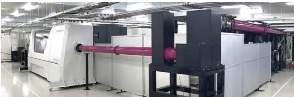
100J級のレーザ（写真左）とビーム配管（紫色の配管）
