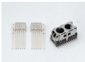
▲車内ネットワーク通信用フォトIC
