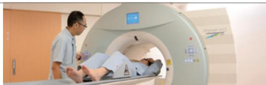
がんや認知症等の診断に用いられるPET検査は、体内の検査薬から発せられるガンマ線をとらえて生体内部の活動を画像化します。そのガンマ線の検出器として、当社の光電子増倍管、MPPCなどの高感度な光センサーが使われております。
