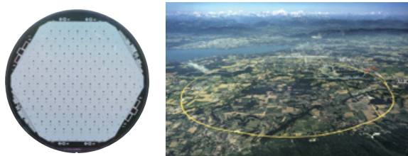
▲左：新たに開発した8インチピクセルアレイディテクタ。 右：本実験は、黄色い円状の地下に設置された前身の実験装置をアップグレードして行われる予定です。
