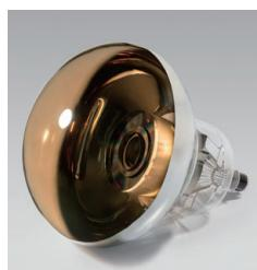
新型20インチ径光電子増倍管
