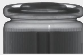
車載用リチウムイオン二次電池 X線撮像例
