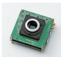
▶ 科学計測用CMOSカメラ
