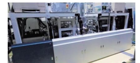
上:100 Jのパルスレーザを10 Hzで出力する装置の外観
