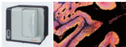
▲開発した「MoxiePlex」(左)とそれを用いて取得した結腸組織の多波長蛍光画像(右)
