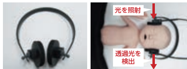
▲開発した透過型プローブ（左）と測定風景イメージ（右）
