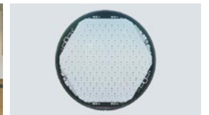
3種類のシリコンセンサのうちの1つである8インチパッド・ディテクタ
