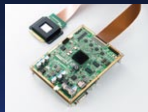
LCOS-SLMモジュール: 手軽に産業分野などに応用できるよう、小型・低価格化した装置組込型。
