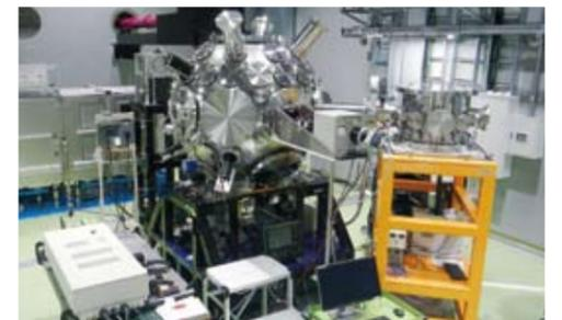
ビーム配管(写真奥、紫色の配管)、チャンバ(写真中央)とストリークカメラ(チャンバ右側)
