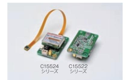
MPPCを内蔵した微弱光検出が可能なモジュール製品を用意しています。MPPCの動作に必要なアンプ・温度補償回路・高圧電源回路などを搭載しており、外部より電源(±5 V)を供給するだけで簡単に動作可能です。MPPCを直接基板に実装したC15522シリーズとフレキシブルケーブル付MPPCを搭載したC15524シリーズの2タイプがあります。
