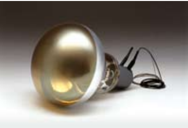
カミオカンデ用20インチ光電子増倍管
