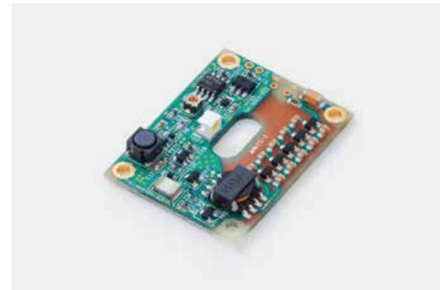
チェッカーランプ専用の駆動回路です。チェッカーランプを接続して電圧を供給するだけで動作可能です。また、点灯補助用にLEDが搭載されており、チェッカーランプ点灯時に瞬時的に点灯します。チェッカーランプ点灯後は消灯します。
