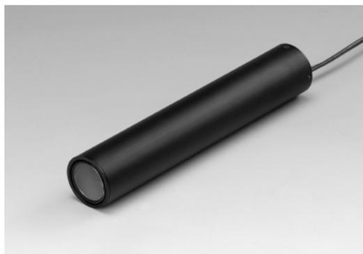
H11123は、φ28 mm (1-1/8")ヘッドオン型光電子増倍管と高圧電源回路、高速フォトンカウンティング回路を内蔵したフォトンカウンティングヘッドです。受光面がφ25 mmと広いため効率よく光を集めることができます。光電子増倍管の高電圧やディスクリミネータの設定はすでに調整してありますので、+5 Vを入力するだけでフォトンカウンティング計測が行えます。
