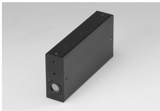
H11526シリーズは、ゲート動作が可能な光センサモジュールです。ゲート専用回路とメタルパッケージ光電子増倍管の組合せにより、最小ゲート幅 100 ns、繰り返し10 kHzの特性が得られています。高圧電源回路が内蔵されているため、+15 Vの低電圧で動作でき、コントロール電圧を調整することで光電子増倍管のゲインを変えることができます。また、強い光が入射した場合、過大光モニタが動作し、エラー信号が出力されます。
