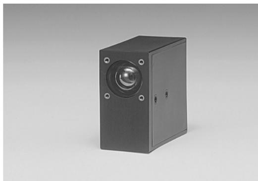
H7828シリーズは、φ19 mm (3/4")ヘッドオン型光電子増倍管と高速フォトンカウンティング回路、高圧電源回路を内蔵した小型フォトンカウンティングヘッドです。光電子増倍管の高電圧やディスクリミネータの設定はすでに調整してありますので、+5 Vを入力するだけでフォトンカウンティング計測が行えます。小型でも有効受光面サイズはφ15 mmと大きいので効率良く光を集めることができ、また他の光電子増倍管モジュールと比較して耐振動衝撃特性に優れていますので、携帯型装置に適しています。
