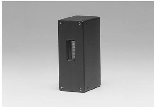
H8259シリーズは、φ28 mm (1-1/8")サイドオン型光電子増倍管と高速フォトンカウンティング回路、高圧電源回路を内蔵したフォトンカウンティングヘッドです。近赤外域に感度のある光電子増倍管は、熱雑音によるダークカウントが大きくなりますが、低ノイズの光電子増倍管を選別しているため、高SNの測定が可能です。光電子増倍管の高電圧やディスクリミネータの設定はすでに調整してありますので、+5 Vを入力するだけでフォトンカウンティング計測が行えます。
