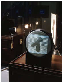
ブラウン管に映し出された「イ」の字 (写真は再現装置によるもの)
