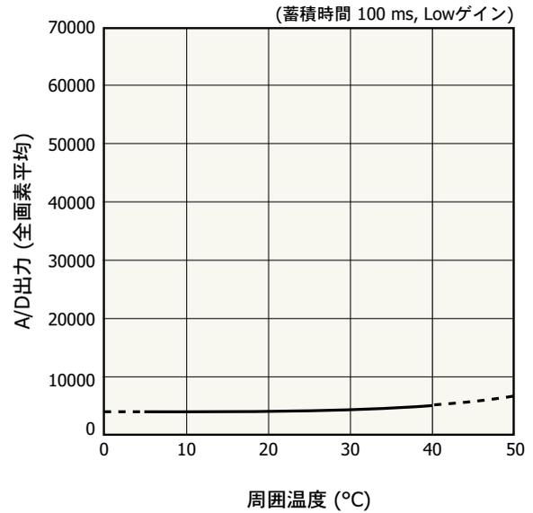
A/D出力は、センサおよび回路のオフセット出力とセンサ暗出力が加算されたものです。
