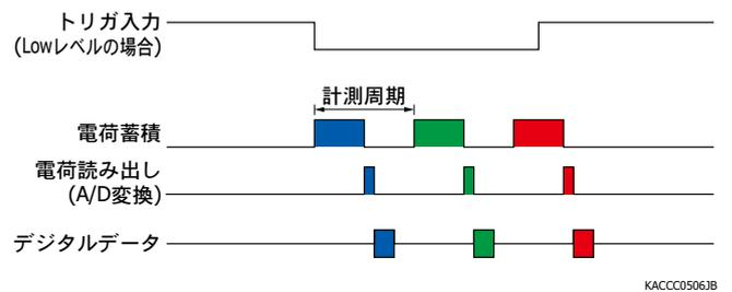
(1) ~ (6)のいずれのモードでも、トリガ入力間隔が分光器の計測周期より短い場合には、入力されたトリガは無視されます。
