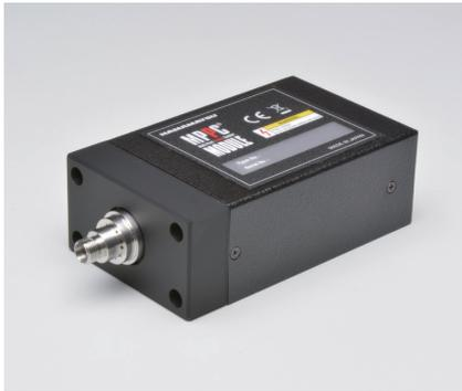
C13001-01は、ファイバカップリング型シングルフォトンアバランシェダイオード (SPAD) の評価用モジュールです。ファイバカップリング型SPAD、アンプ、コンパレータ、SPADバイアス回路、温度コントローラから構成されています。外部から電源 ( $\pm 5$  V) を供給すると動作します。C13001-01は、C14076-01とほぼ同じ機能を持っています。なおC13001-01は、放熱処理が不要です。
