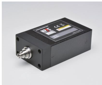
C16533-050GDは、ファイバカップリング型シングルフォトンアバランシェダイオード (SPAD) の評価用モジュールです。ファイバカップリング型SPAD、アンプ、コンパレータ、SPADバイアス回路、温度コントローラから構成されています。外部から電源 ( $\pm 5$  V) を供給するだけで動作します。C16533-050GDは、C16534-050GDとほぼ同じ機能をもっています。なおC16533-050GDは、放熱処理が不要です。
