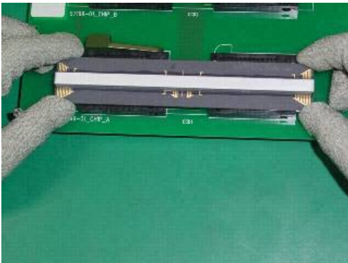
[写真 7] 基板を押し込んで挿入する
