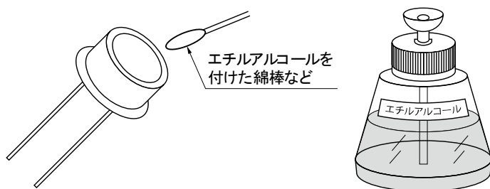
〔図1〕窓材の汚れは、エチルアルコールを付けた綿棒などを用い、軽くふき取る
