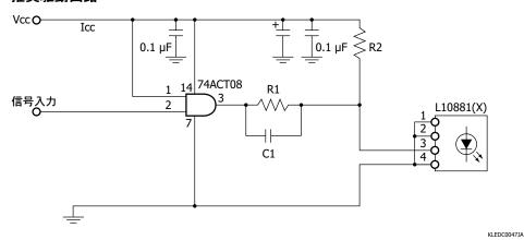
入力信号は156 Mbpsの疑似ランダムバイフェーズ信号とする (NZR信号換算)。 \$\phi\$1 mm SI-POF、NA=0.5 (三菱レイヨン GH4001)、平均値 (デューティ50 %時) Vcc=5.0 V, R1=100  $\Omega$ , R2=300  $\Omega$ , C1=20 pF
