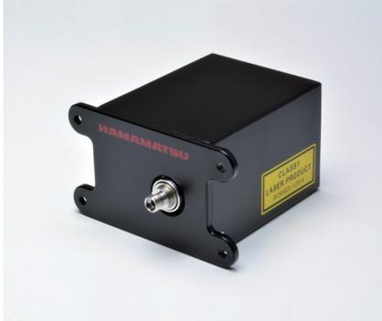
手のひらサイズの筐体に、マイケルソン光干渉計と制御回路を内蔵した小型のフーリエ変換型近赤外分光器です。PCとUSB接続することにより、スペクトルや吸光度の測定ができます。
