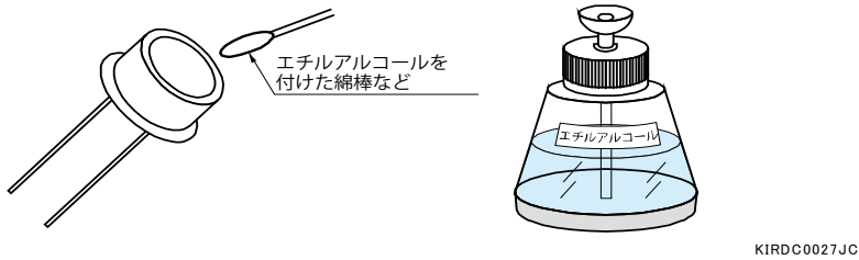
【図 1】窓材の汚れは、エチルアルコールを付けた綿棒などを用い、軽くふき取る
