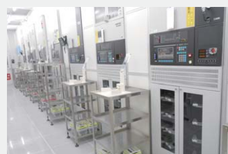
酸化炉、CVDによってウエハ上に薄膜を形成
