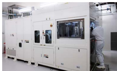
MOCVD装置による薄膜結晶の形成
