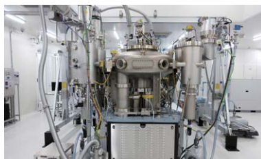
MBE装置による超高真空中の薄膜結晶の形成
