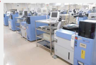
ウエハ状態におけるデバイスの電氣的・光学的検査
