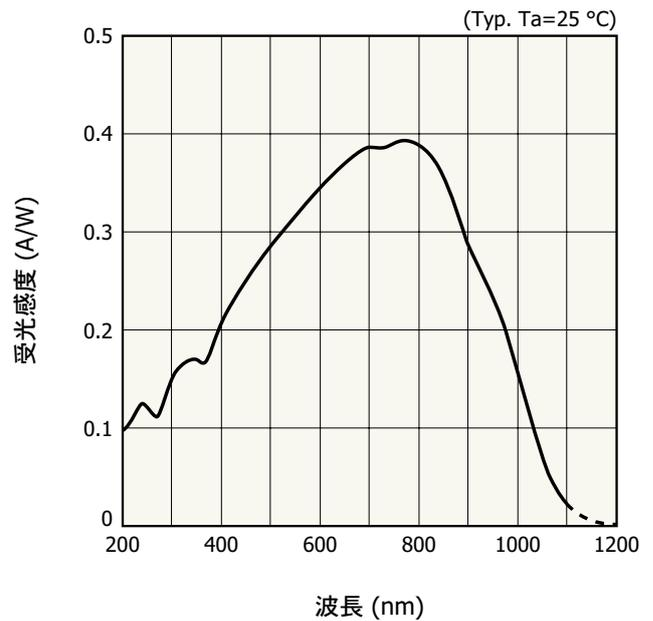
\*17: 石英ガラス窓の場合には、透過率特性により分光感度は低下します。
