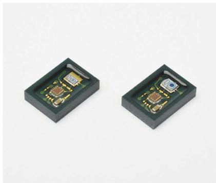
S15415シリーズとトランスインピーダンスアンプを一体化した直接TOF (Time-of-Flight)方式の距離計測用デバイスです。低ノイズ、高速応答を実現しています。
