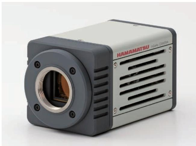
InGaAsカメラ C12741-03は、950 nm ~ 1700 nmの近赤外領域で感度を有したカメラです。14 bitの画像取得や露光時間の調整が可能なUSB 3.0インターフェースを装備しています。
