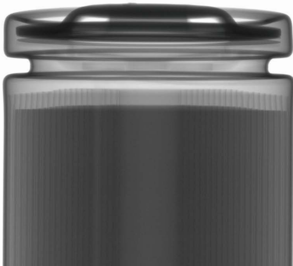
円筒型リチウムイオン電池 (LiB) のX線画像
