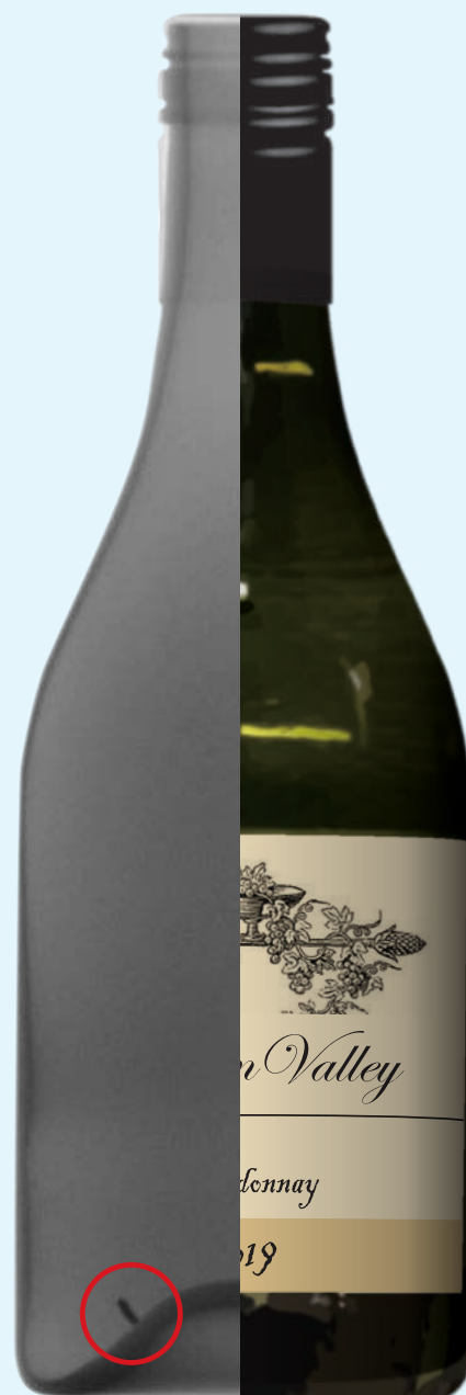
▲ ピンの異物検査 (左：X線画像、右：可視画像)
