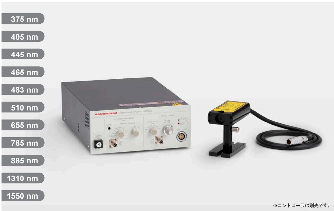
PLP-10は、レーザダイオード (LD) を用いた超短パルス光源です。専用のコントローラを組み合わせ使用します。375 nm~1550 nmまでの波長範囲で11タイプをラインアップしており、蛍光寿命測定用の励起光源をはじめ、受光素子の応答特性評価、光記録媒体の特性評価等に使用することができます。
