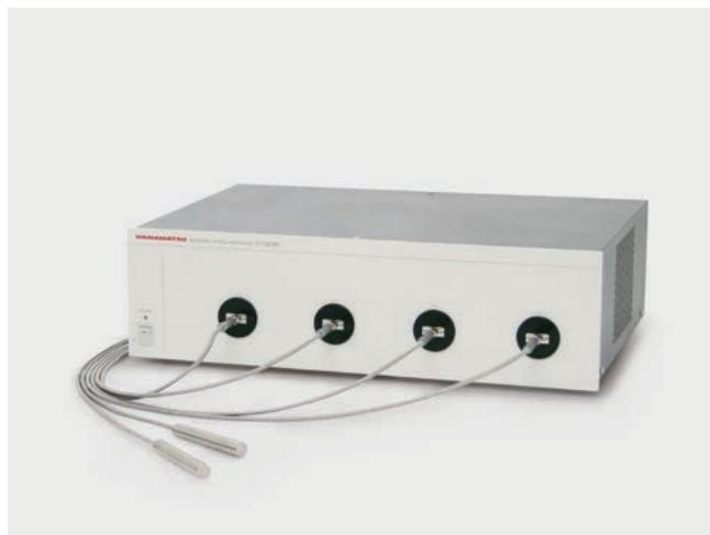
Multipoint NanoGauge 膜厚計 C11295 は、分光干渉法を利用した膜厚測定装置です。半導体製造工程における膜厚測定をはじめ、半導体製造装置へ搭載するAPCやフィルムの品質管理のために膜厚の測定をする装置です。リアルタイムでのマルチポイント計測が可能で、多チャンバ同時計測やフィルム面上の多点計測を実現します。また、膜厚と同時に反射率(透過率)・物体色、それらの経時変化も測定することができます。
