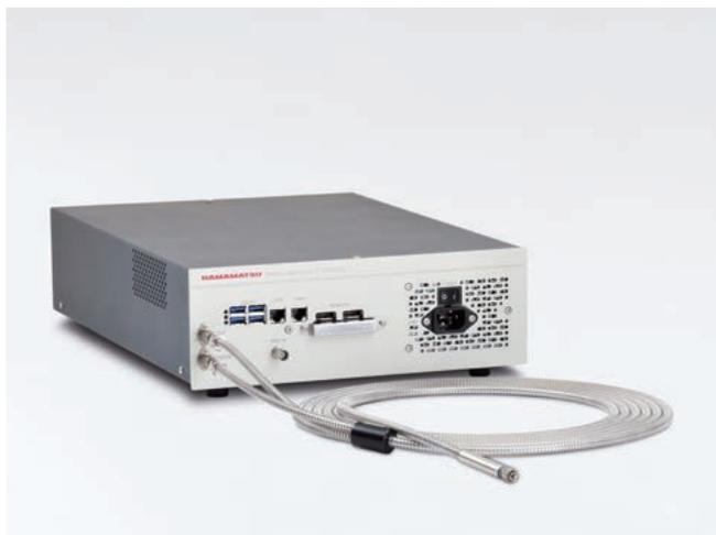
Optical NanoGauge 膜厚計 C12562は、関連装置への組み込みを前提に設計された非接触の膜厚測定装置です。半導体市場では貫通電極技術の採用によりシリコン厚の測定が重要視され、フィルム市場では接着層の薄膜化が進み、共に1  $\mu\text{m}$  ~ 300  $\mu\text{m}$ の範囲での高精度な厚み測定が必要とされています。C12562の測定範囲は、500 nm ~ 300  $\mu\text{m}$ と幅広く、薄膜塗工厚からフィルム基板厚、さらには総厚まで測定可能です。また、最高100 Hzの高速測定も可能なため、高速ラインでの測定にも対応します。
