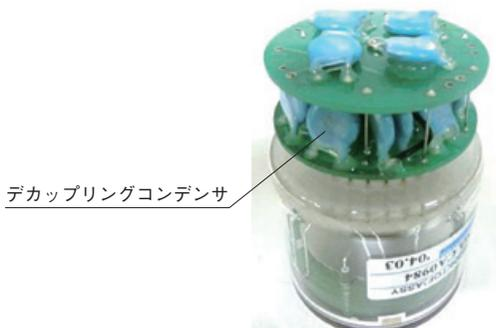
図5-24 パルスリニアリティ対策を施した光電子増倍管アッセムブリ
