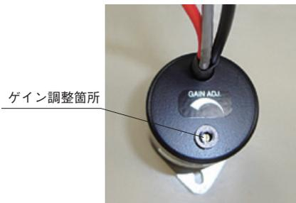
図 5-34 外部からゲイン調整用の可変抵抗を備えた DA 型ソケットアセンブリ
