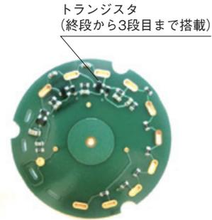
図 5-12 アクティブ型デバイダ回路の例
