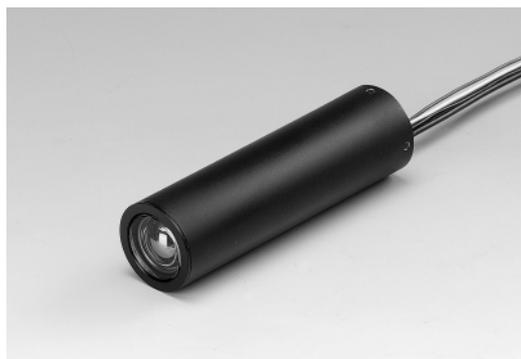
H10492シリーズは、φ25 mm (1")ヘッドオン型光電子増倍管と高圧電源回路、低雑音アンプを内蔵した光センサモジュールです。アンプは、電流電圧変換係数1 V/μA・周波数帯域DC~20 kHzタイプと0.1 V/μA・200 kHzタイプ、0.1 V/μA・DC~8 MHzタイプがあり、光電子増倍管は可視域用と可視~近赤外域用を用意しています。
