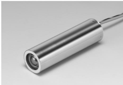
H9319シリーズは、内蔵のマイクロプロセッサでカウントリニアリティ補正を行い、ランダムパルス入力時 $20 \times 10^6 \text{ s}^{-1}$ まで計数損失 $\pm 1\%$ 以内で補償するフォトンカウンティングヘッドです。 $\phi 25 \text{ mm}$  (1")ヘッドオン型光電子増倍管、フォトンカウンティング回路、高圧電源回路、カウンタ、マイクロプロセッサを内蔵しています。
