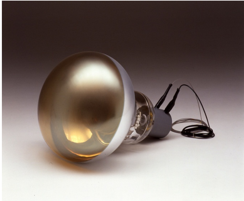
カミオカンデ用20インチ光電子増倍管
