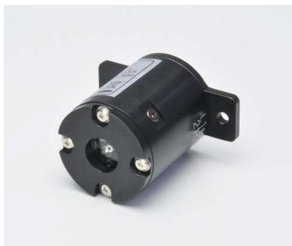
近赤外分光分析法の拡散反射計測を行うためのランプと光ファイバを内蔵したモジュールです。ランプから試料に光を照射し、試料内部に入り込み拡散・反射した光を光ファイバに導入します。近赤外分光器などに接続して使用します。複数のランプと光ファイバを近接して配置した本製品を用いることにより、試料から放出される微弱な拡散光を効率よく検出できます。
